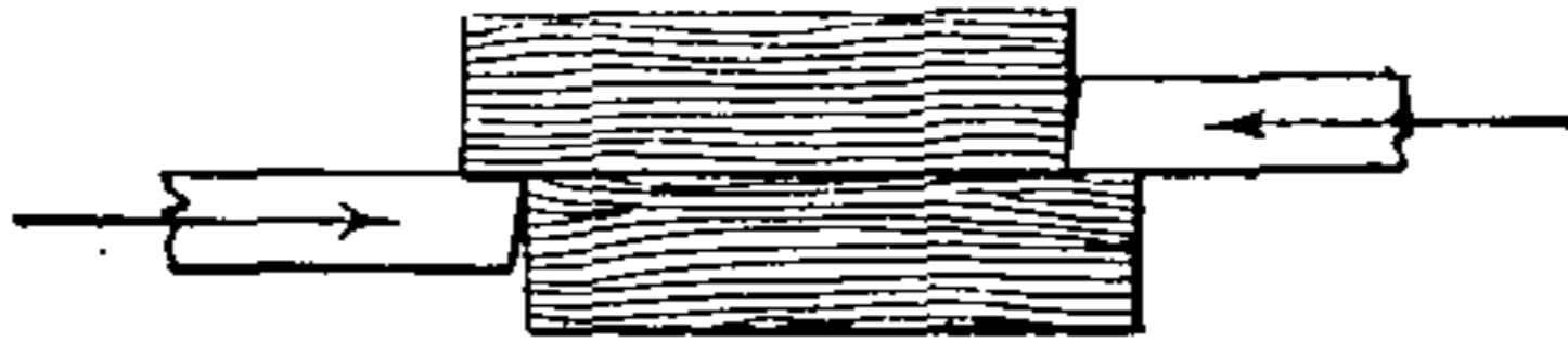
Fig. 111. — Essai mécanique des colles par le procédé Bauschinger.
