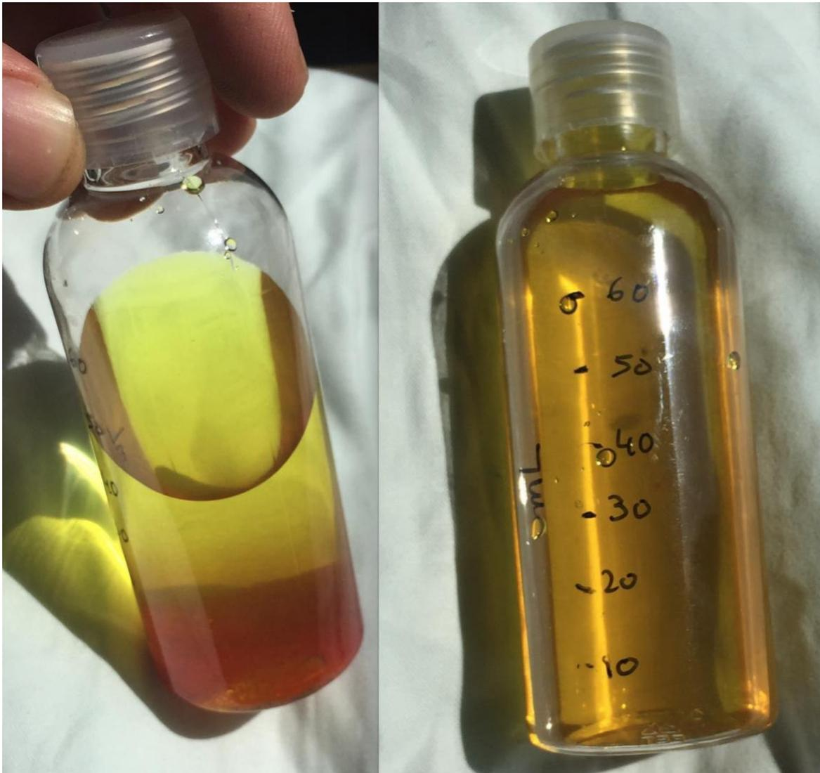
A noter qu'à 20°C, on peut dissoudre au max 460g de Ferri dans 1L d'eau, donc 23g max dans 50mL d'eau. Au delà, il y aura toujours des cristaux au fond.
