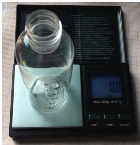
Ici j'ai dissous 6g de ferrocyanure de potassium avec 50mL d'eau pour obtenir la solution A :
