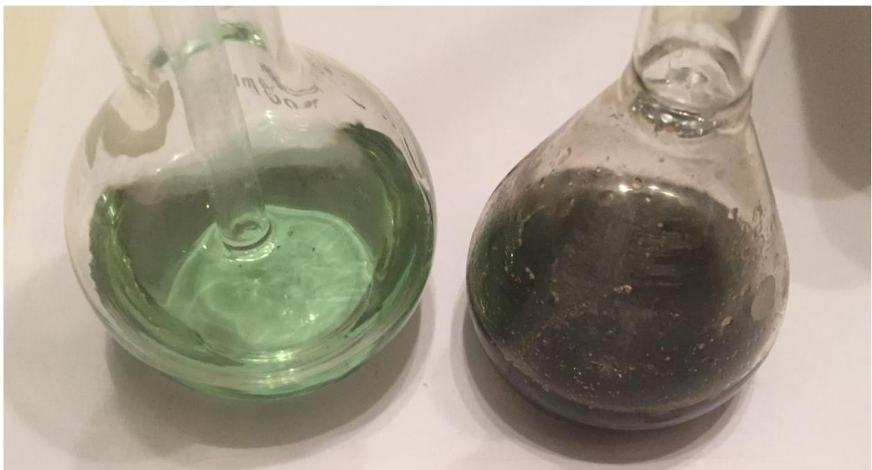
On replonge ensuite de fer dans la solution filtrée (encore acide) pour revenir à l'étape de l'attaque du fer par l'acide.
