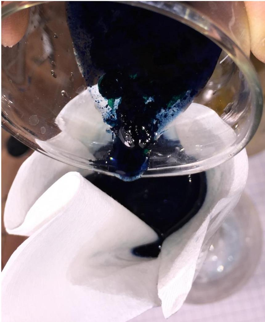
C'est pour cela qu'il est important que les composés soient bien dissouts, sinon ils vont être retenus par le filtre avec le BP !
