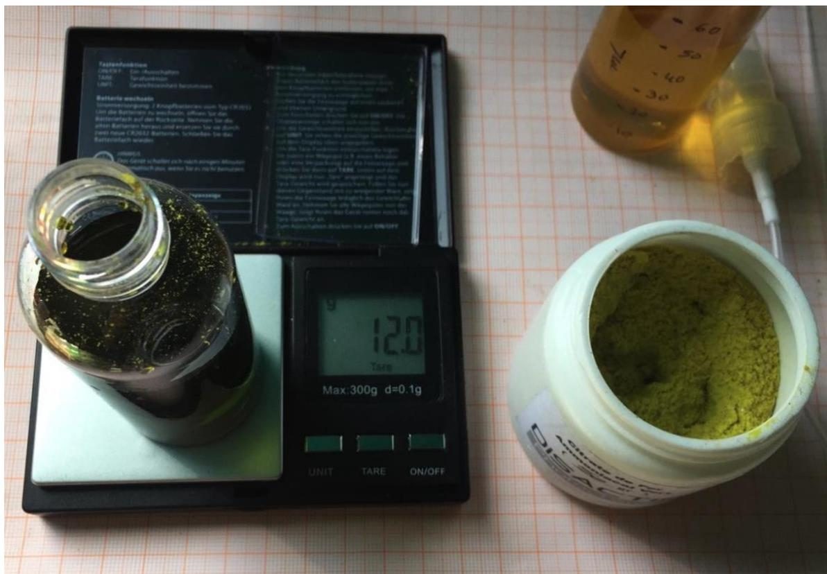
Il faut attendre un peu pour que la dissolution soit complète, c'est fini quand la solution est homogène sans cristaux au fond.
