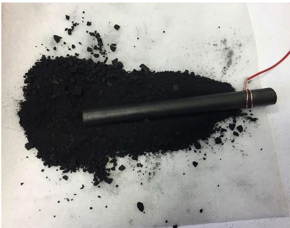
Elle est ensuite enveloppée dans notre papier-tissu avec une électrode au milieu. C'est le même process qu'avec la pile aluminium-air.
