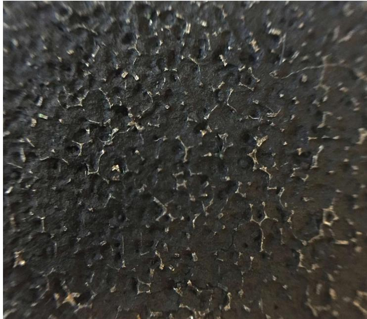
Il n'est pas impossible que le métal réalise une réaction parasite dans notre pile. On remarque cependant qu'une électrode de fortune faite d'un charbon de pile et de granulés broyés permet d'atteindre de bons résultats.
