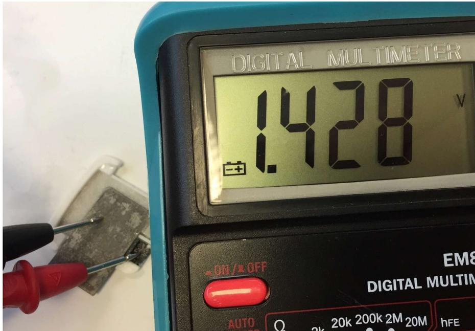
Cette plaque A permet une tension de 1,9V avec son électrode de charbon actif A. Avec le charbon B, la tension n'est que de 1,4V. On peut en conclure que la qualité de l'électrode de charbon joue un rôle très important dans la qualité finale.
