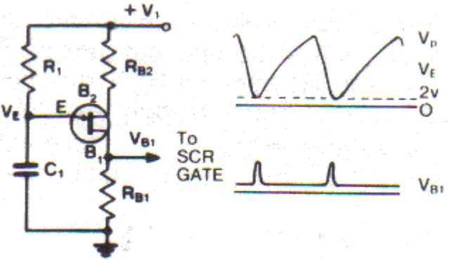
**BASIC UNIUNCTION TRANSISTOR RELAXATION OSCILLATOR-TRIGGER CIRCUIT WITH TYPICAL WAVEFORMS**
