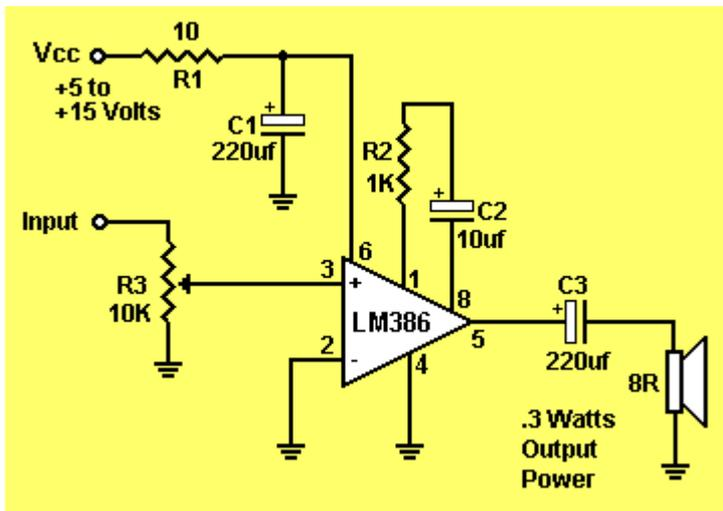
300mW amplifier using LM 386
