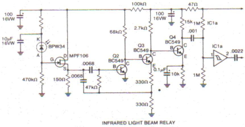
INFRARED LIGHT BEAM RELAY
