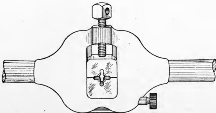
Fig. 85. Threading Die Holder
