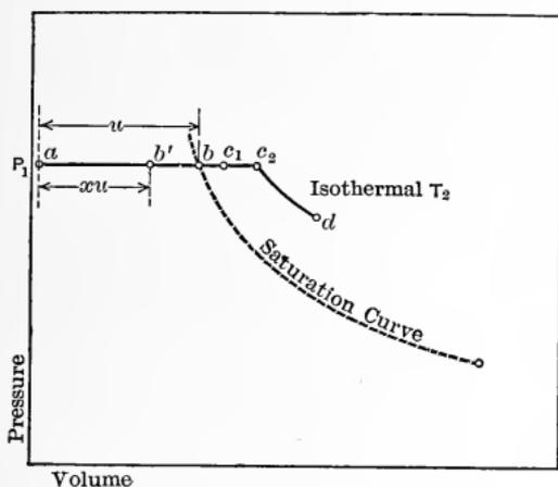
Fig. 46. — PV-Diagram for Vapor.
