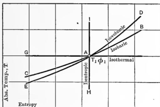
Fig. 15. —  $T\phi$ -Curves for Gases.
