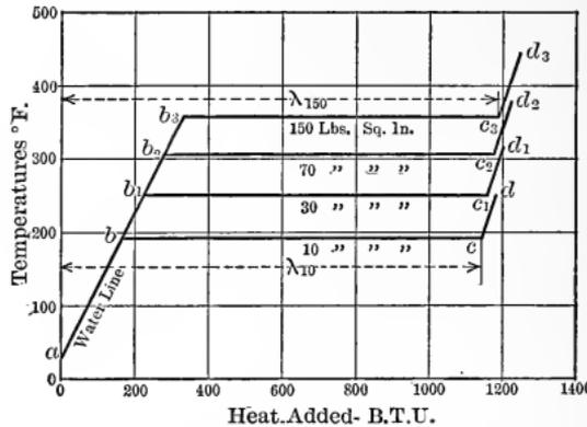
Fig. 31. — TQ-Diagram for Vapor Phenomena.
