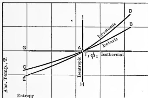
Fig. 15. —  $T\phi$ -Curves for Gases.
