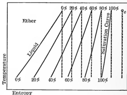
Fig. 49. —  $T\phi$ -Diagram for Ether Vapor.
