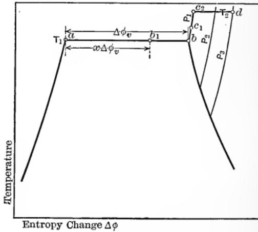
Fig. 47.—Tφ-Diagram for Vapor.
