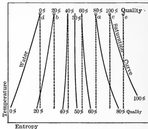
Fig. 48. —  $T\phi$ -Diagram for Water Vapor.
