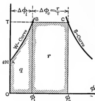
Fig. 41. —  $T\phi$ -Diagram for Water Vapor.
