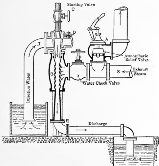
Fig. 432. — Ejector Condenser.
